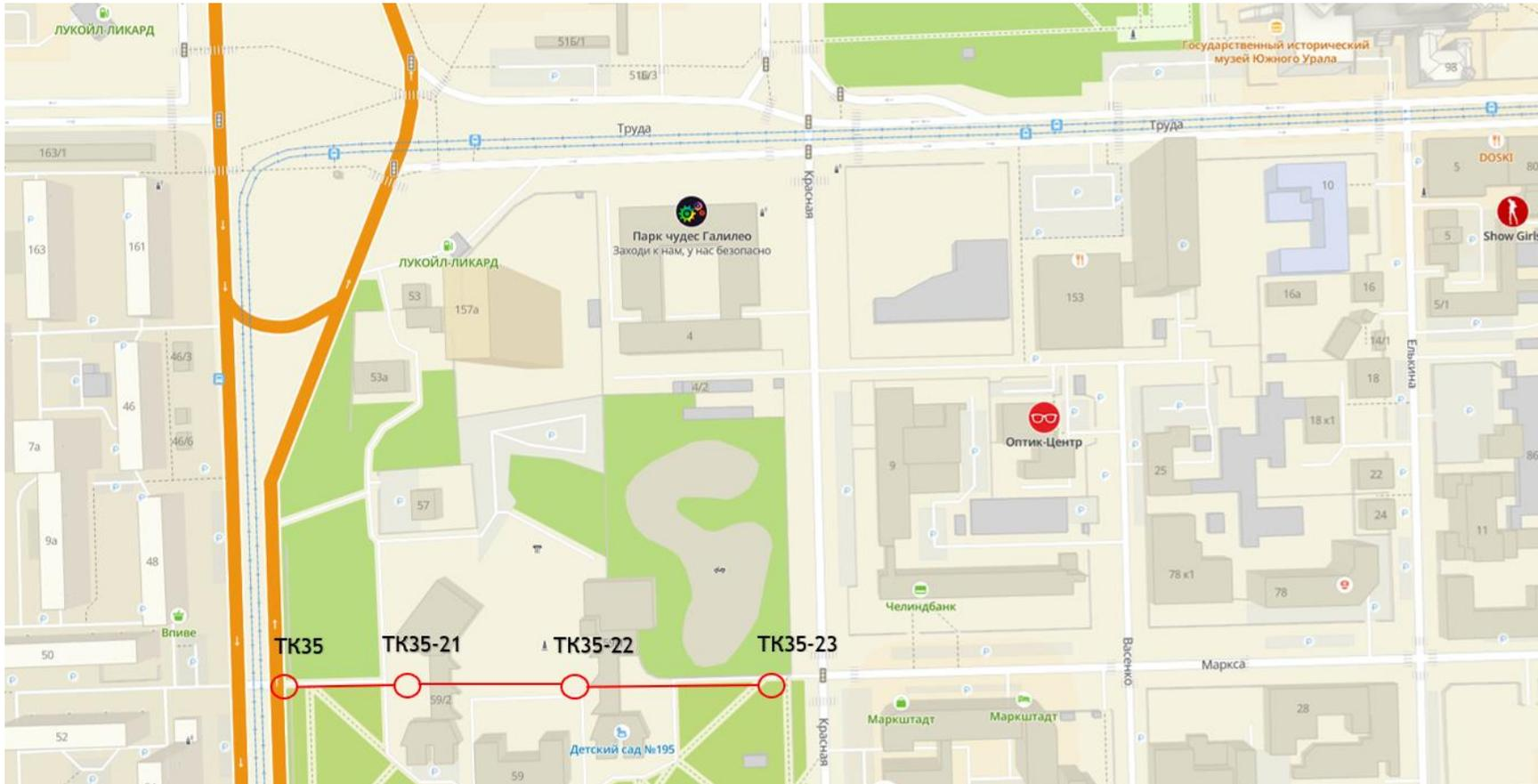
**Реконструкция участка теплотрассы по ул. Карла Маркса от ТК35 до ТК35-23 Ду=300, Lk=260 м канала.**
