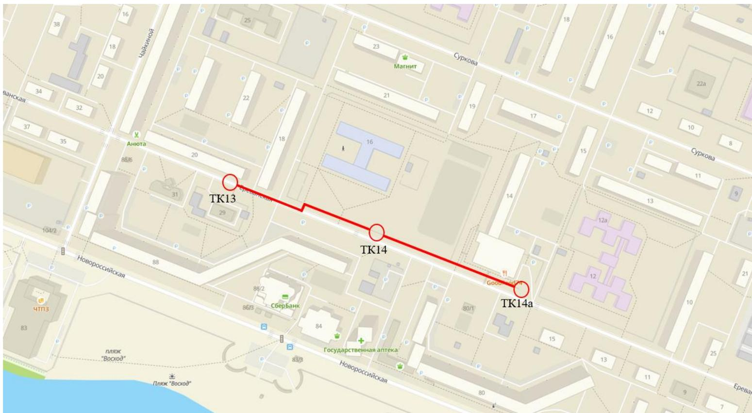
**Реконструкция участка теплотрассы ТЭЦ-1 – ЧКПЗ от ТК-13 до ТК-14а по ул. Ереванской в ППУ изоляции Ду=500, Lк=370м.**
