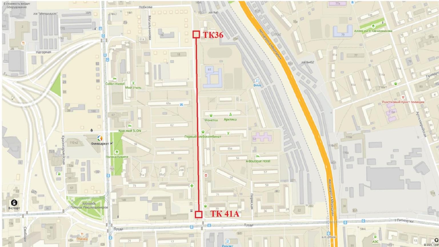
**Реконструкция участка 5 тепломагистрали ТЭЦ-4 от ТК-36 до ТК-41а Ду=700, Lк=549 м по III Интернационала в ППУ изоляции.**
